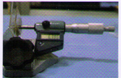
数显外径千分尺 用于测量样品厚度 型号：42200
