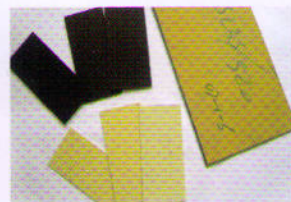
切割的纤维板材试样
