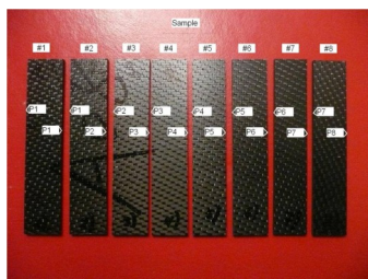
碳纤维板材试样切割
