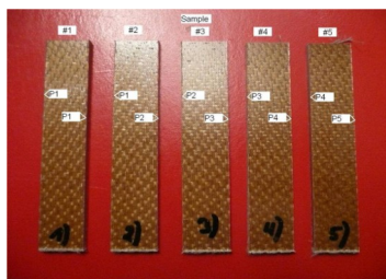
芳纶板材试样切割
